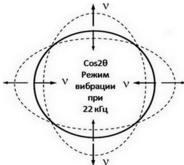
Рис. 6.15. Деформация пьезоэлемента за счет продольного пьезоэффекта
