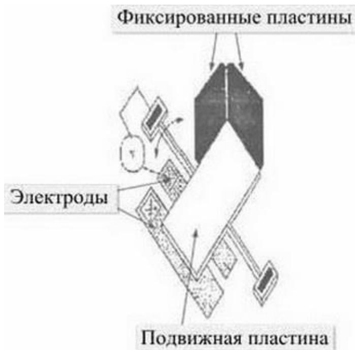
Рис. 11.10. Схематическое изображение углового кубического отражателя
