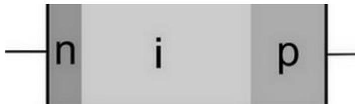
Рис. 10.10. Диффузионно-дрейфовый  $p-i-n$ -диод
