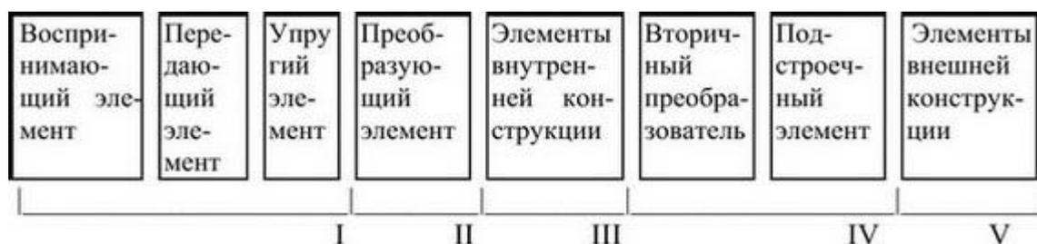
Рис. 4.4. Структурная схема интеграции элементов тензорезистивного преобразователя давления
