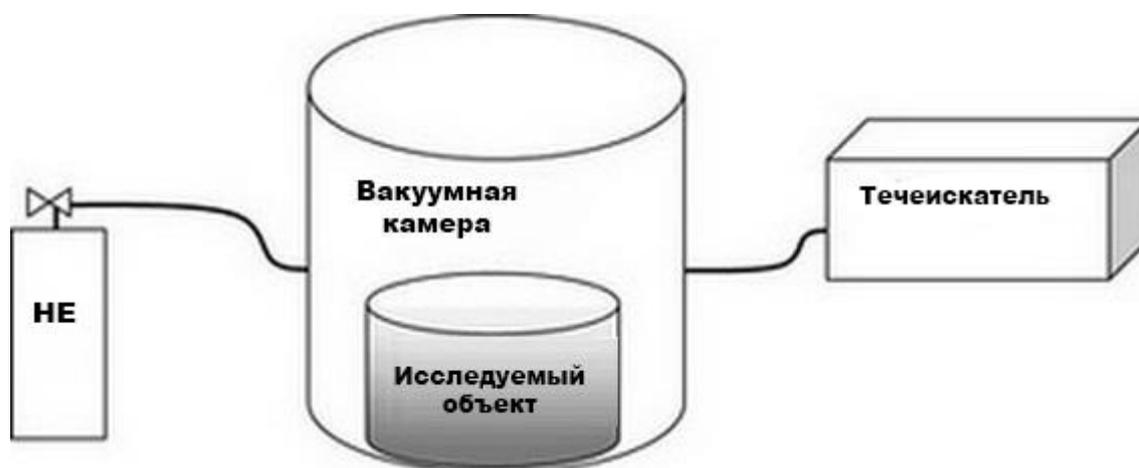
Рис. 13.6. Глубоковакуумный метод поиска течей
