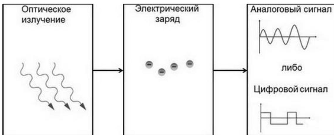
Рис. 9.1. Техническая идеология датчика изображения
