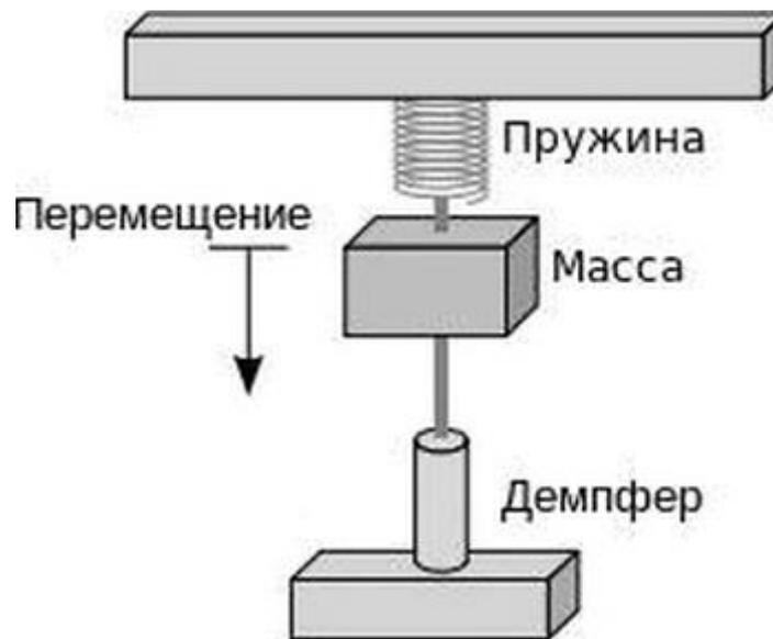
Рис. 6.2. Акселерометр
