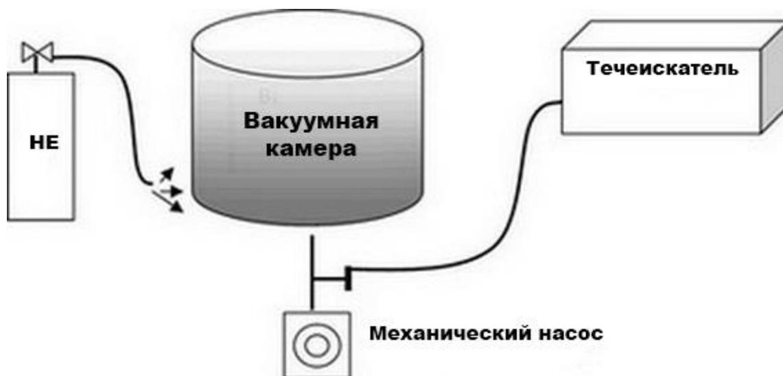
Рис. 13.5. Вакуумный метод поиска течей
