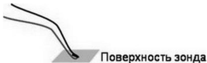
Рис. 5.28. Тепловой контакт как типичный источник погрешности
