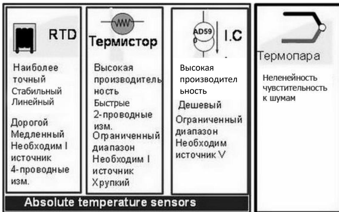
Рис. 5.30. Оценка использования термодатчиков в конкретной ситуации
